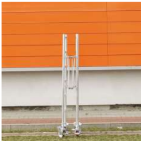
4) Foto del ponteggio chiuso con ruote rosse
