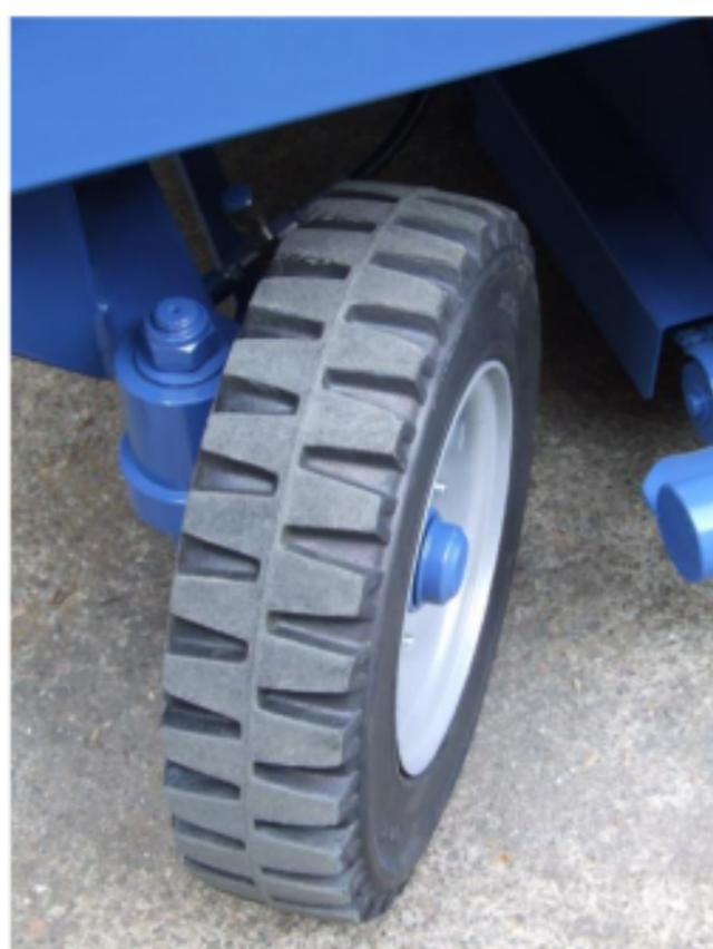
Le batterie permettono un'elevata autonomia di lavoro e una lunga durata nel corso del tempo, dotata di ruote in gomma da 400 mm. (disponibili anche in versione anti-traccia), indicatore di planarità, controllo elettronico del carico nel cesto, 2 livellatori manuali, indicatore di carica delle batterie, caricabatterie elettronico, lampeggiante e avvisatore acustico di movimento.
