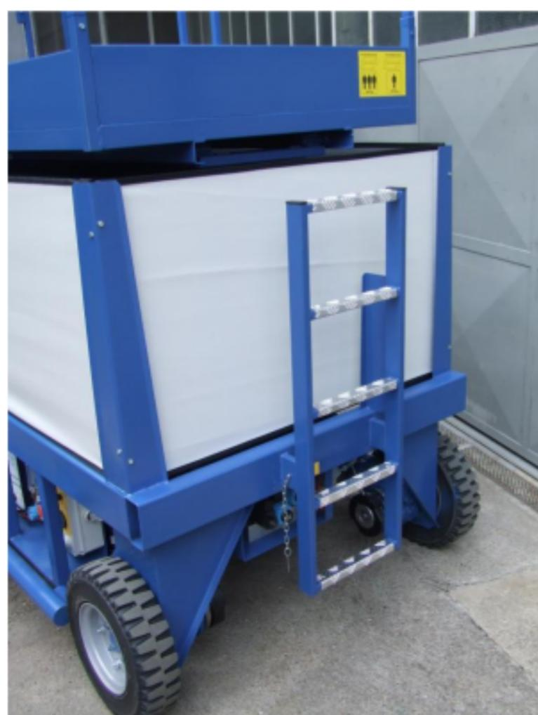
Il punto di forza di questa piattaforma è la possibilità di traslare quando è completamente sviluppata, un sistema anti-ribaltamento assicura stabilità e sicurezza in ogni condizione.
