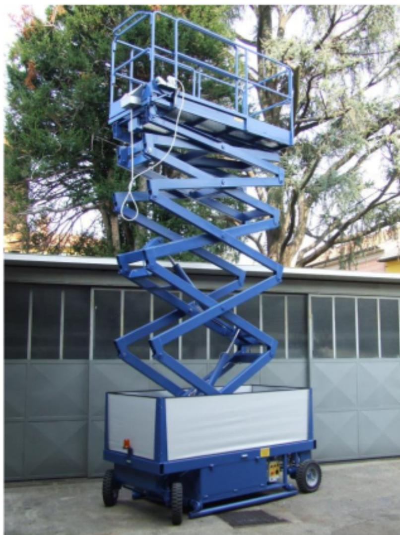
Piattaforma a pantografo traslante in quota, grazie alla conformazione del telaio di base assicura un'eccellente stabilità mantenendo un peso contenuto che la rende trasportabile con la maggior parte dei veicoli con patente B.
